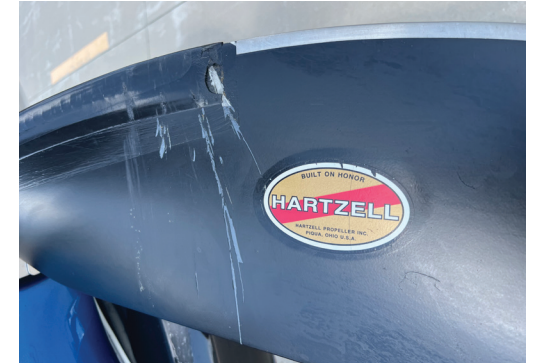
Reparierbarer Schaden durch Vogelschlag
