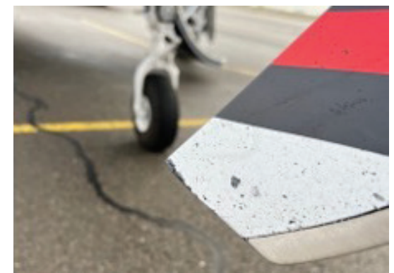
Beispiele für Flugtauglichkeitsschäden an Verbundwerkstoffblättern
