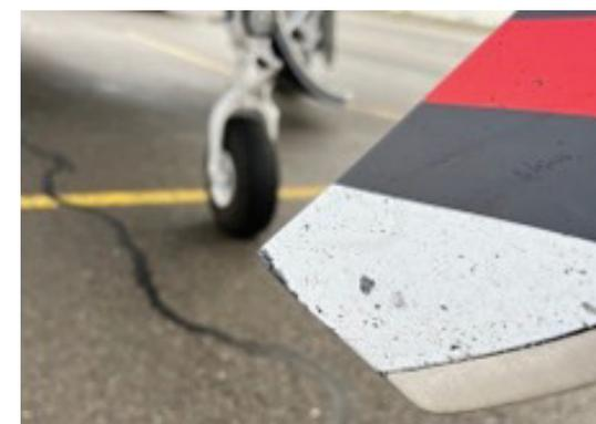
*Ejemplos de daños aéreos en las palas de material compuesto*
